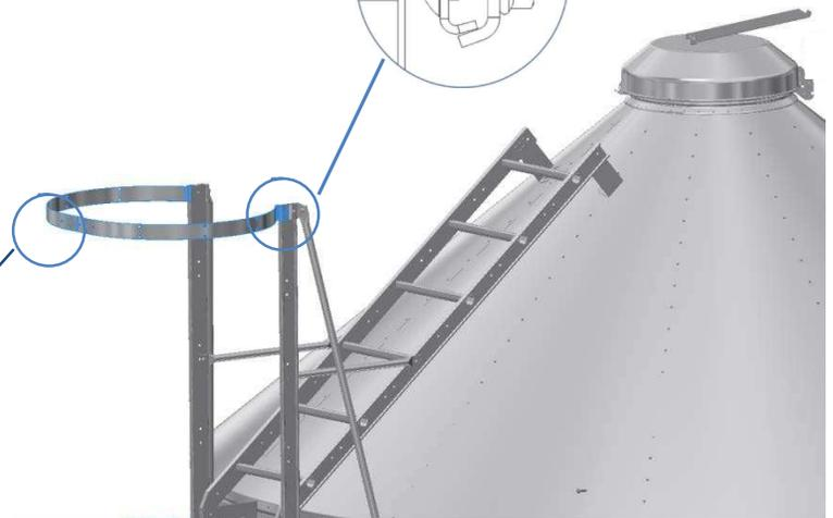
8. Coloque los tubos de extensión a la parte interior de las piezas curvas y fíjalo con el tornillo de cabeza segmentada HS714 y la tuerca de borde roscado HS722
