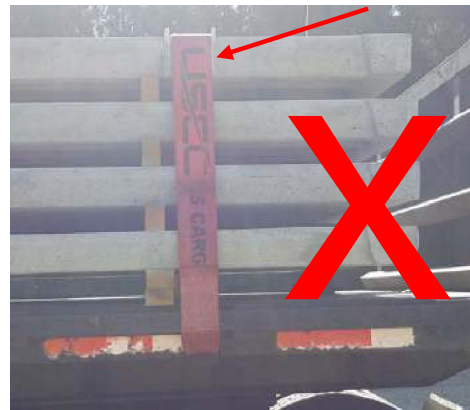
Ubicación incorrecta de la correa de amarre porque la correa está fuera de la madera de estiba
