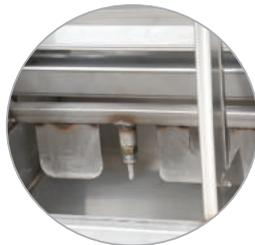
Desatornille la placa lateral y deslice todo el conjunto de la barra de agua interior fuera del corte.
