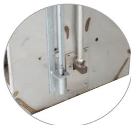
La barra de agua de dos piezas ayuda al mantenimiento. La tubería vertical se retira fácilmente de la barra horizontal.
