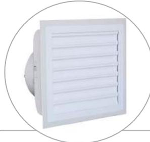
Las persianas de PVC blanco tienen varillas de acero de resorte de longitud completa en lugar de pasadores de plástico en los extremos que se bloquean en un marco de PVC pesado con esquinas reforzadas. Las paletas de la persiana de superficie de sustentación reales reducen la resistencia del aire
