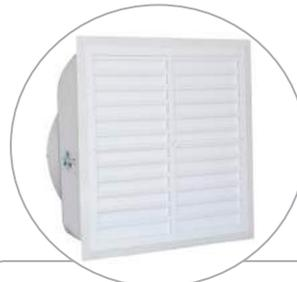
Las persianas de PVC blanco tienen varillas de acero de resorte de longitud completa en lugar de pasadores de plástico en los extremos, que se bloquean en un marco de PVC pesado con esquinas reforzadas. Las paletas de la persiana de perfil real reducen la resistencia del aire.
